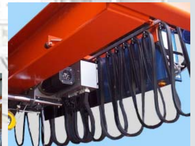
Stromzufuhr über C-Schienen. Steuertaster unabhängig von der Laufkatze verfahrbar.
