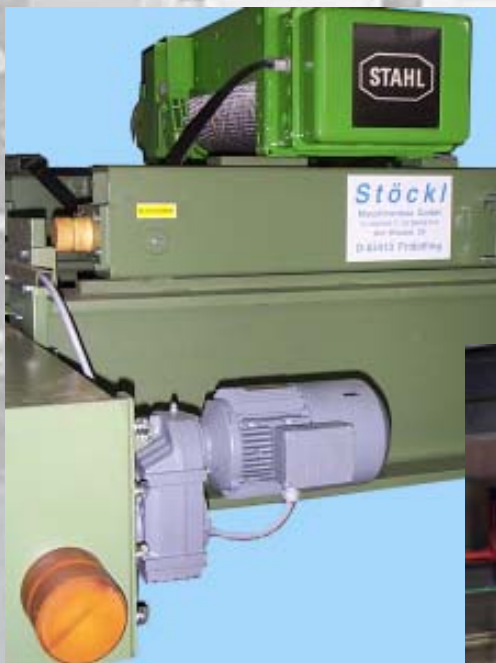
2-Träger Brückenkran mit Obergurt-Laufkatze
