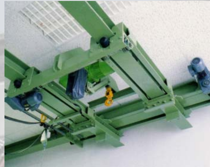
Deckenbefestigter Zweiträger-Hängekran mit Kettenzug. Extreme Hubhöhe.
